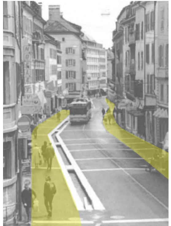
Das Foto des Projekts im Jurybericht von 1995 lässt erkennen, was dem Projekt 25 Jahre später zum Vorwurf gemacht wird. Die Passanten bleiben wegen der häufig vorbeifahrenden Busse (ungefähr im Drei-Minuten-Takt) auf «imaginären Trottoirs gefangen».
